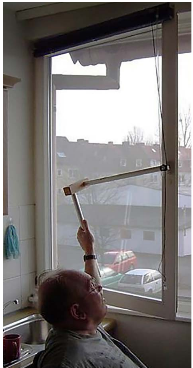
Mit einem manuellen Fensteröffner kann der Fenstergriff auch im Sitzen erreicht werden.
