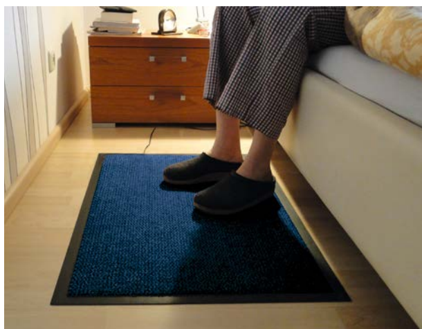
Durch Berührung der Sensormatte wird das Licht auf dem Nachtschrank angeschaltet.
